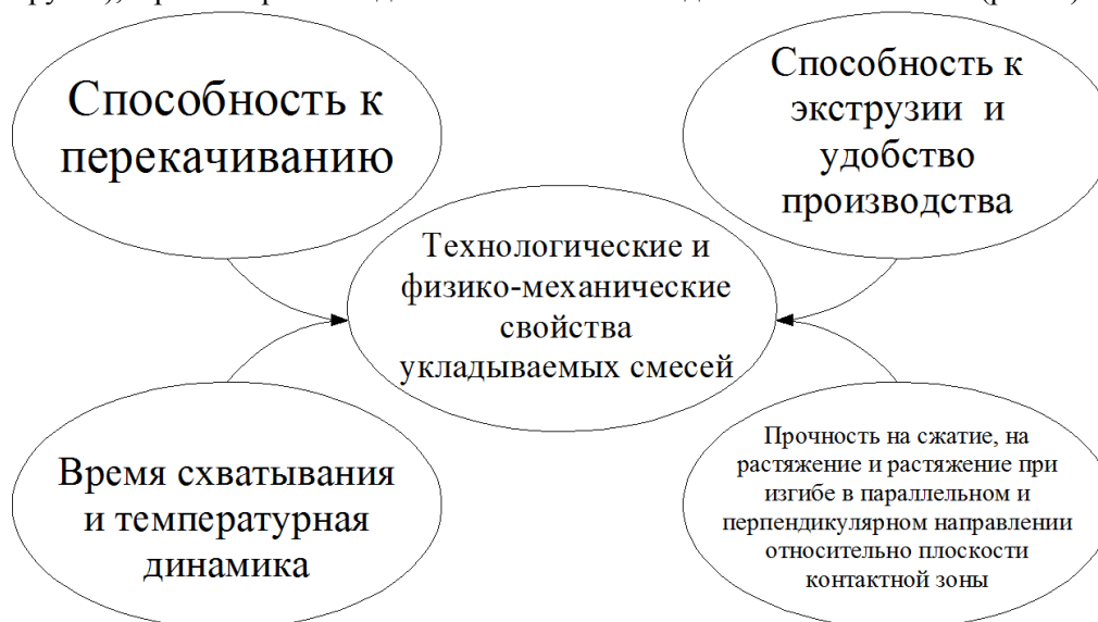
Рис. 4. Технологические и физико-механические свойства укладываемых смесей
