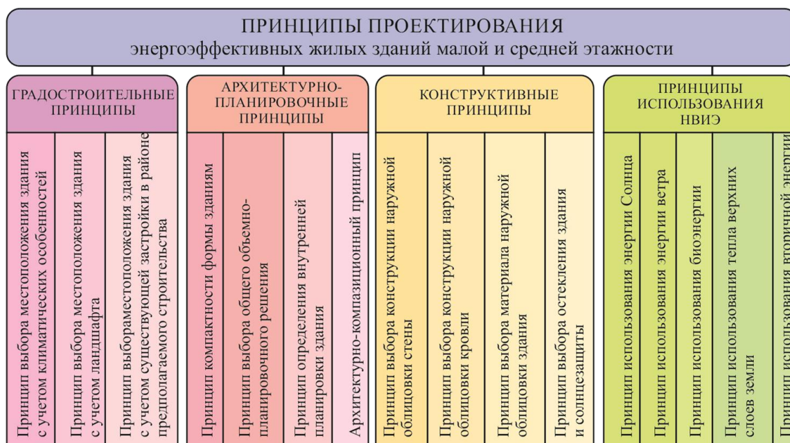
Рис. 3. Основные принципы проектирования энергоэффективных жилых зданий малой и средней этажности [7]
